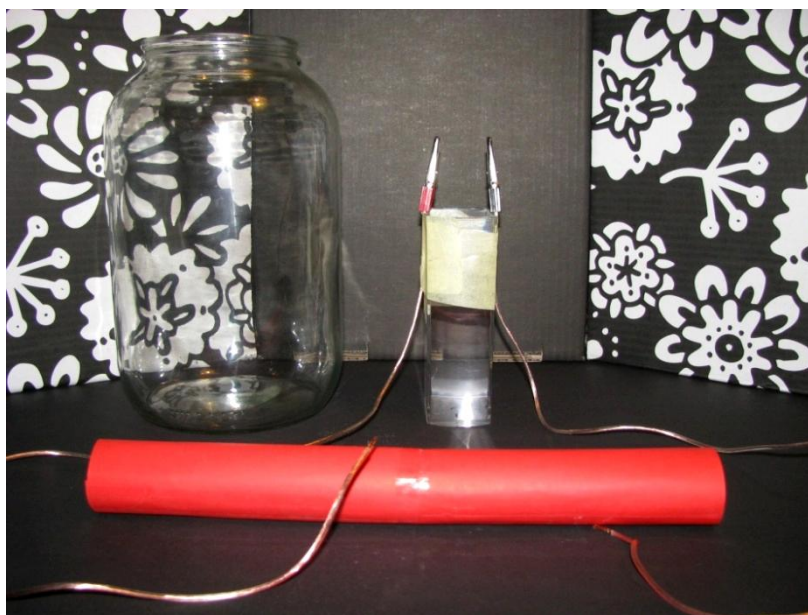
Na zdjęciu: wykonany wspornik z przewodami oraz tuba z bateriami, a także słoć, który posłuży za bańkę żarówki.
