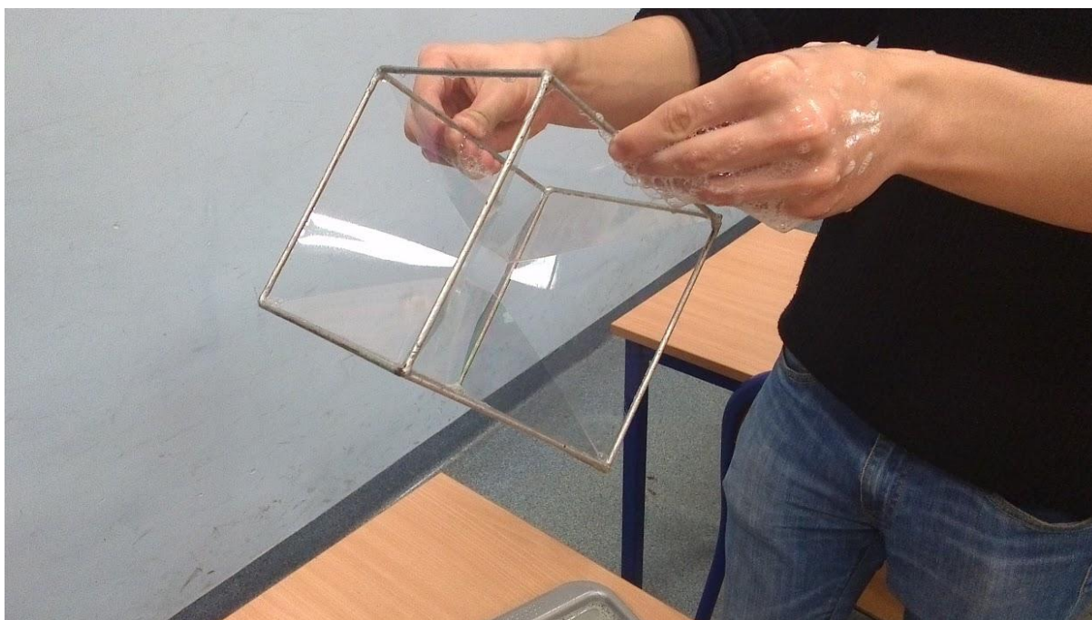
Błony rozpięte na krawędziach sześcianu tworzą dwa ścięte ostrosłupy.
