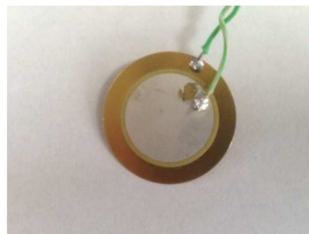
Rys. 11. Element piezoelektryczny z przylutowanym przewodem. Źródło: własne
