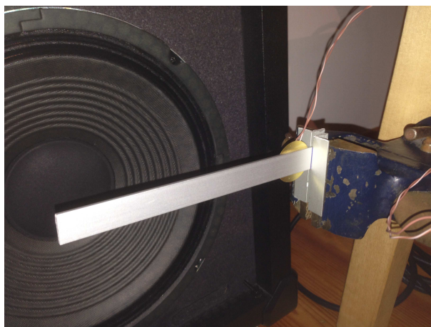
Rys. 20. Mocowanie układu odbiornika Źródło: własne
