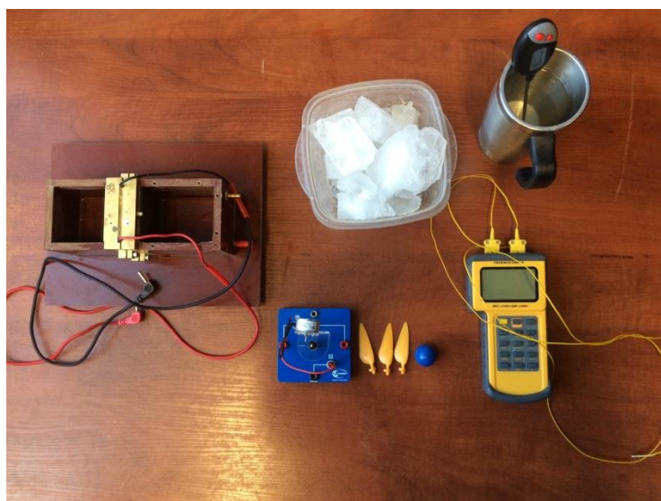
Rys.4. Elementy użyte do budowy układu pomiarowego demonstrującego efekt Seebecka.
