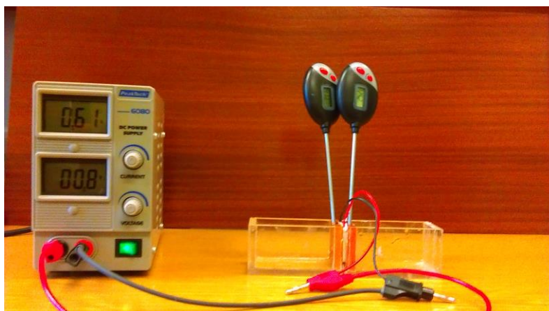
Rys. 6. Układ pomiarowy do demonstracji zjawiska Peltiera
